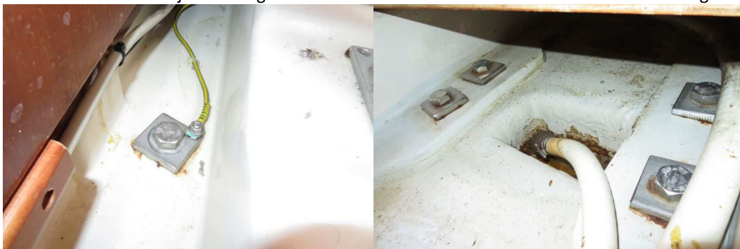
Keel bolt without corrosion
