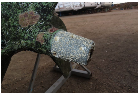
Propeller nut anode
